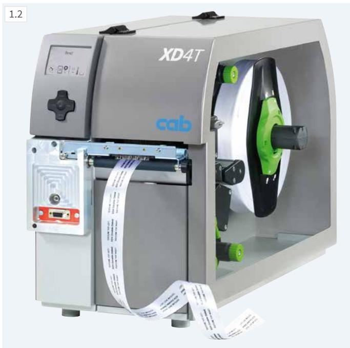
Er bedruckt auf beiden Seiten Textilbänder, Kartonetiketten, flachgepresste Schläuche endlos oder konfektioniert, sowie Endlosmaterialien aus Kunststoff, Papier oder Karton. Eine Zugwalze trennt die Transferfolie von den Materialien und verbessert zusätzlich die Eindruckgenauigkeit.
