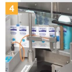
Elektronische Positionsanzeigen und motorische Höheneinstellungen unterstützen den schnellen Formatwechsel und ermöglichen sehr kurze Rüstzeiten.
